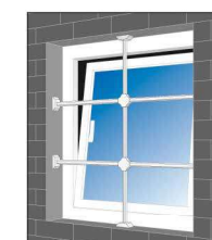
Instalación en el intradós
