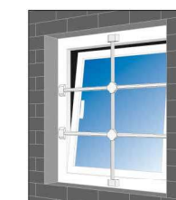
Instalación en el marco de la ventana
