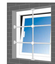
Instalación en el intradós
