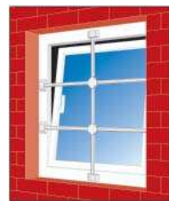
3 montaje sobre el marco de la ventana
